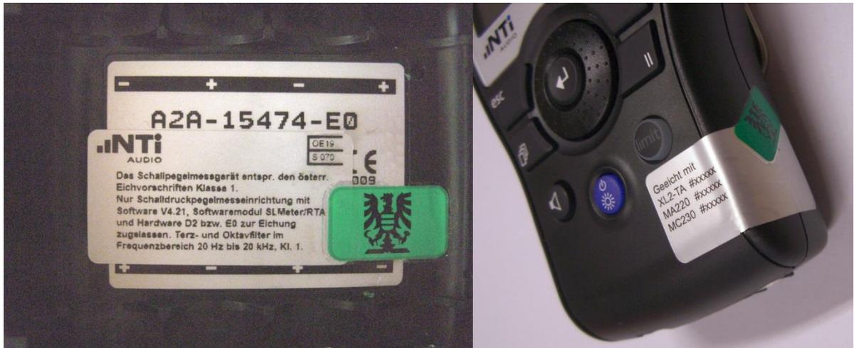
*Typenschild im Batteriefach mit Sicherungszeichen, Seriennummern mit Sicherung gegen Öffnen*
