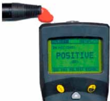
用 ML1 内置麦克风测试适配器
