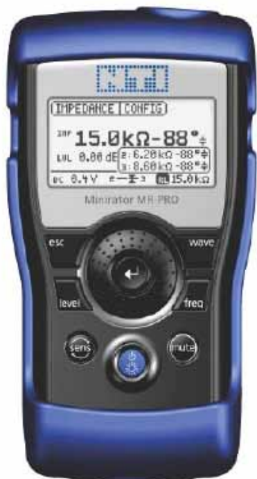
一条5米音频线引脚1 出错的测试结果
