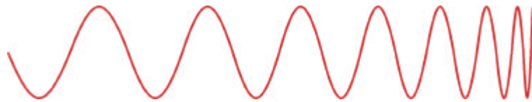
Bild 1, gleitender Sweep („Chirp“)
