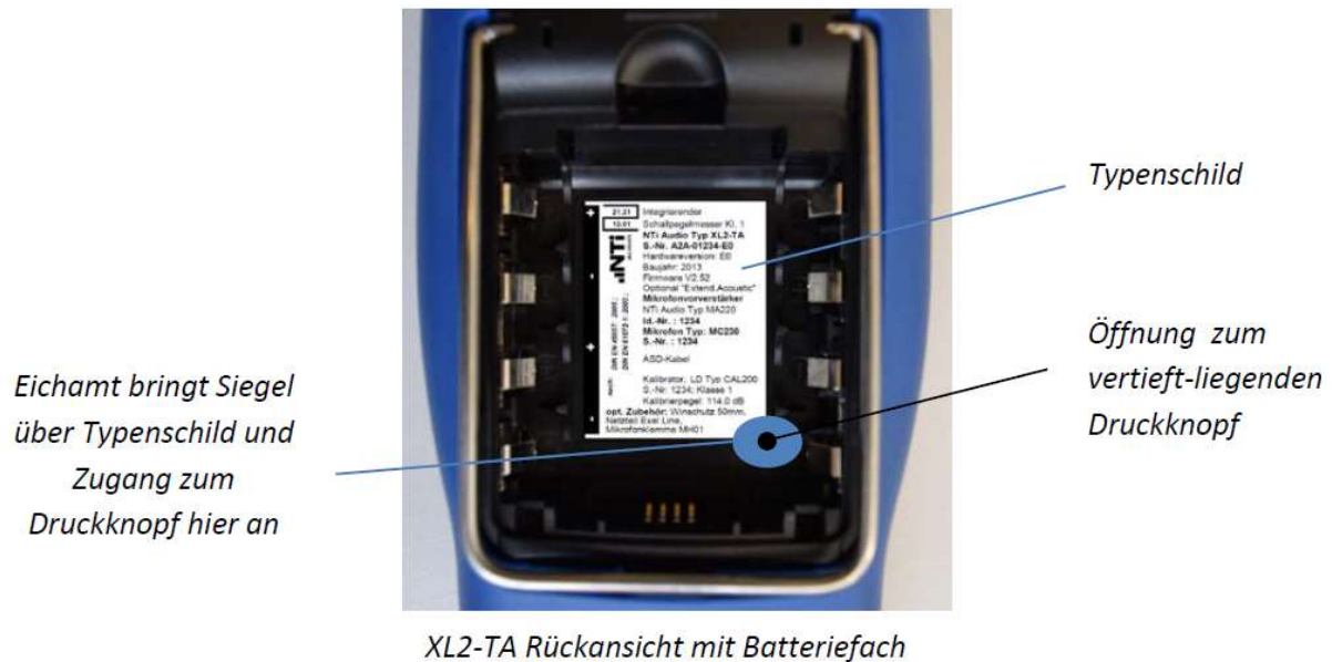
Abbildung 5: Zusätzliche Versiegelungsstelle im Batteriefach (Quelle: NtI Audio AG)
