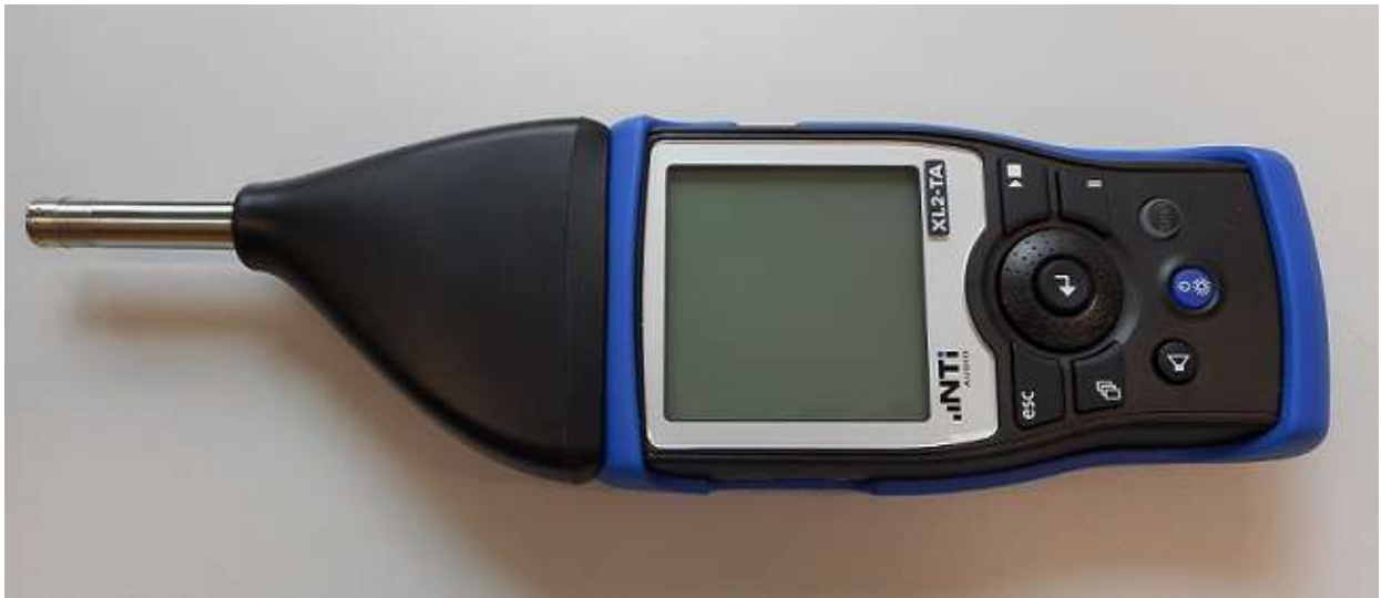
Abbildung 1: Schallpegelmesser mit aufgesetztem Mikrofon und Reflexionsschutz MXA01
