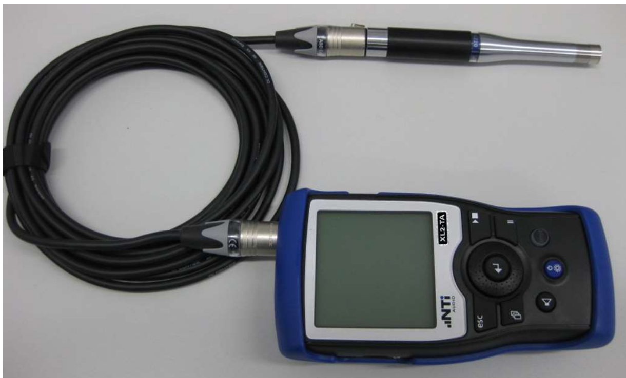
Abbildung 2: Schallpegelmesser mit abgesetztem Mikrofon
