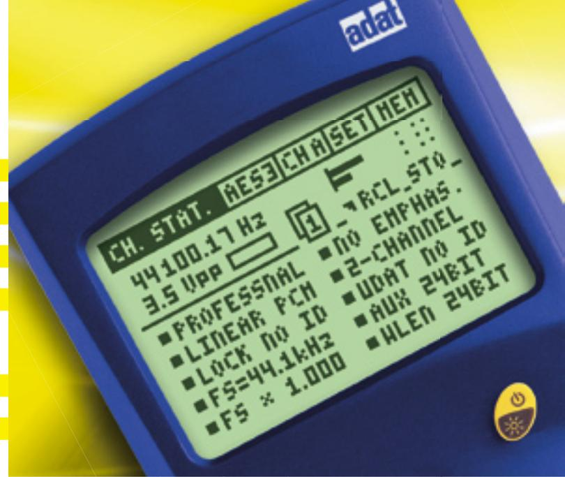
Digilyzer DL1 ist ein leistungsfähiger und einfach zu bedienender, digitaler Audio Analysator. Alle gängigen Audio-Schnittstellen inklusive ADAT mit Abtastfrequenzen bis 96 kHz werden vom Gerät unterstützt. Mit einzigartigen Funktionen wie der Integritätsprüfung, dem eingebauten Mithörlautsprecher, dem Event-Logger, der Audio-Linse usw. werden Abgleich, Überwachung und Fehlersuche an digitalen Audio-Schnittstellen massiv vereinfacht.
