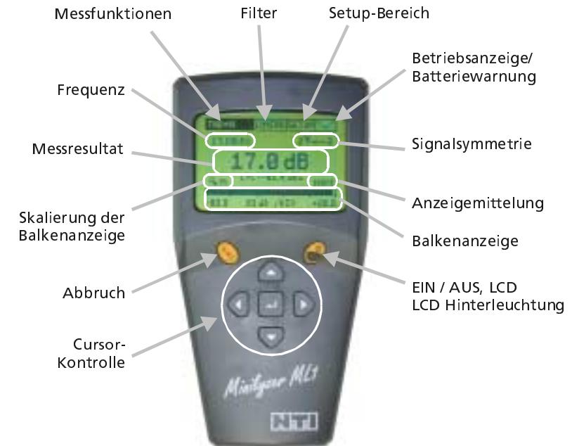
Fig 3 Anzeige- & Kontrollelemente
