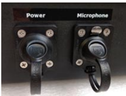
Wasserfeste Steckverbindungen für Mikrofonkabel und externes Netzteil (IP65 Variante)
