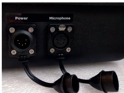
Entfernte Schutzkappen der wasserfesten Steckerverbindung (IP65 Variante)
