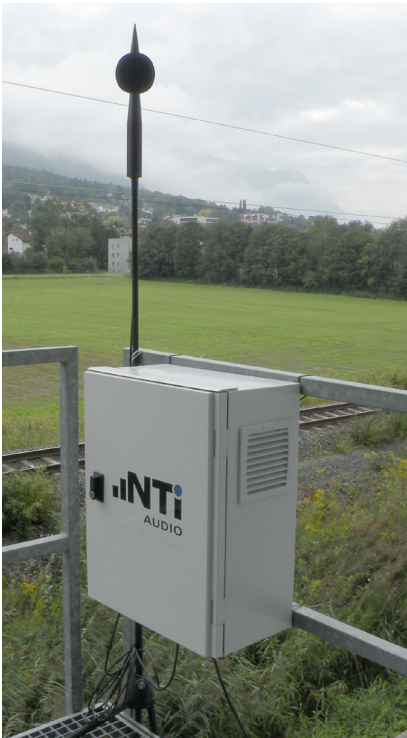
IP55 Lärm-Messstation mit Aussenmikrofon und Dreibein
