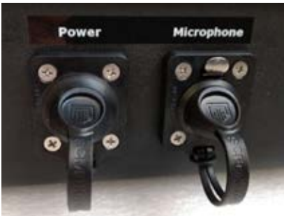
Wasserfeste Steckerverbindungen für Mikrophonkabel und externes Netzteil (IP63 Variante)
