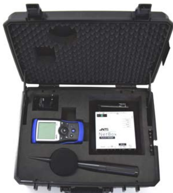
Schutzkoffer mit XL2, Aussen-Messmikrofon, NetBox und Zubehör
