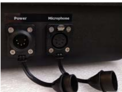
Entfernte Schutzkappen der wasserfesten Steckerverbindung (IP63 Variante)
