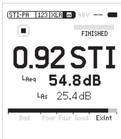
Abb. 11: Darstellung der Messwerte nach einer STI-Messung. Der L_{Aeq} bezieht sich auf den 16 s langen STI Messzyklus.
