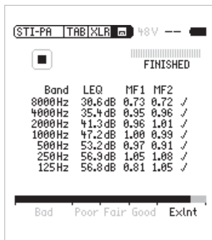
Abb. 12: Details einer STI-Messung mit linear bewerteten Oktavbandpegel sowie den 14 zur STI-PA Messung gehörigen Modulationskoeffizienten
