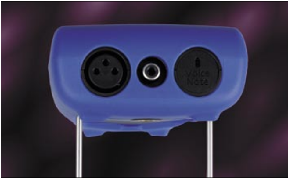
Eingänge für Leitungspegel- und Mikrofonsignale (XLR) mit eingebautem Mikrofon
