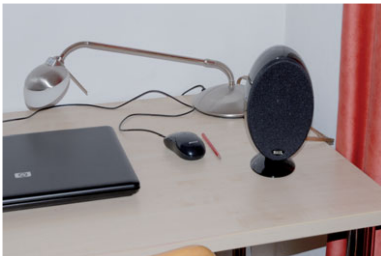
Bild 1: Optimale Aufstellung der Heimkino-Lautsprecher im „missbrauchten“ Büroraum: Eine 20-cm-Verschiebung des Lautsprechers kann massive Verbesserungen (oder Verschlechterungen) bewirken; mit Rosa Rauschen und dem Terz-Analyzer des XL2 lässt sich die beste Position systematisch finden
