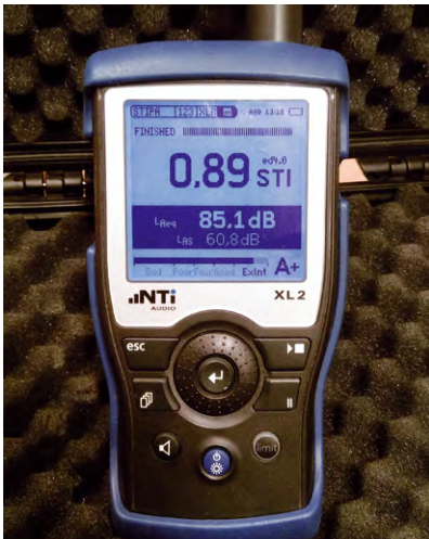
▲ Bild 2: Messung der Sprachverständlichkeit mit NTi Audio XL2
