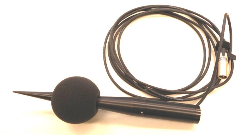
Abbildung 3: Wetterschutzeinheit WP30-90 mit ASD-Kabel
