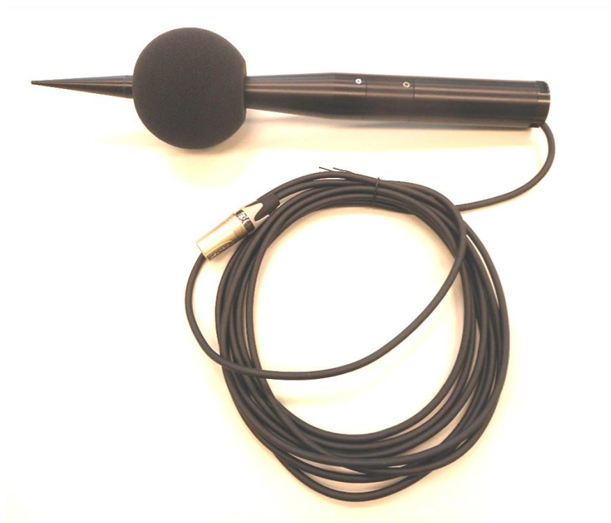
Abbildung 4: Wetterschutzeinheit WP30-90 mit Trockenadapter MTG TA202 (innen, nicht sichtbar), Gehäuseverlängerung WP30-X und ASD-Kabel
