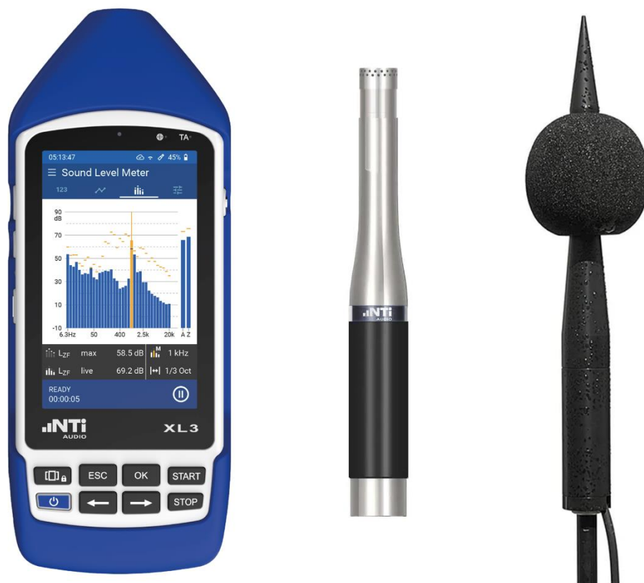
Schallanalysator NTi Audio XL3, Mikrofoneinheit NTi Audio M2340, Wetterschutz NTi Audio WP30-90
