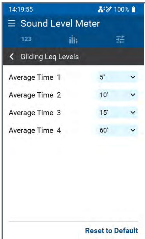
Además del valor medio (L<sub>eq</sub>), que representa todo el periodo de medición desde START hasta la hora de observación STOP, también existen medias móviles L<sub>eqt</sub>, que calculan el valor medio de un periodo de medición definido hasta la hora de observación. El XL3 puede calcular hasta cuatro medias móviles en paralelo para satisfacer distintos requisitos nacionales.
