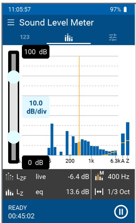
Pulsando prolongadamente sobre los ejes X o Y, puede cambiar la escala correspondiente.
