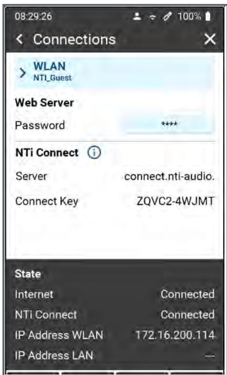
Esta configuración muestra el estado actual de la conexión Wi-Fi y la dirección IP asignada al dispositivo. La dirección IP es importante para la conexión con el servidor web. En NTi Connect puede ver la URL del servidor de conexión y la clave de conexión única de su XL3. Esta clave y la contraseña por definir son los elementos necesarios para una conexión con el instrumento a través de NTi Connect.
