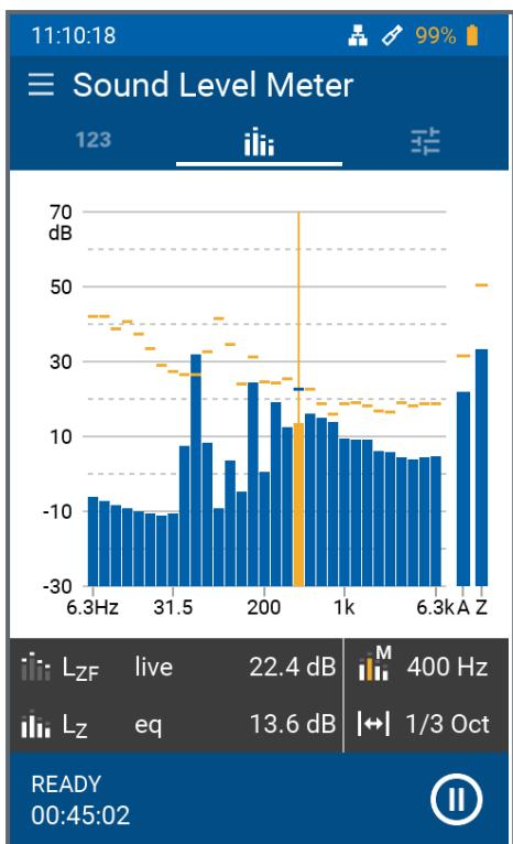
En la visualización espectral se muestran simultáneamente hasta 2 espectros, así como los niveles de banda ancha ponderados A y Z.
