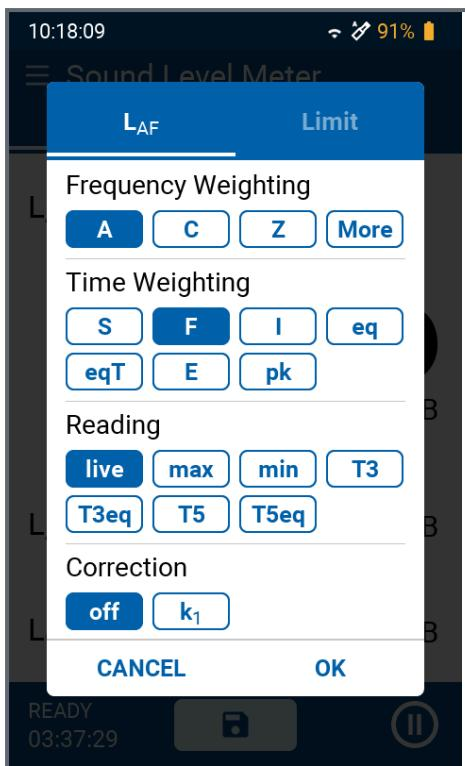
Para visualizar o modificar un nivel específico, pulse sobre la designación de este nivel. Se abre un menú en el que puede seleccionar la ponderación de frecuencia, la ponderación de tiempo y cualquier valor de desplazamiento para este nivel.
