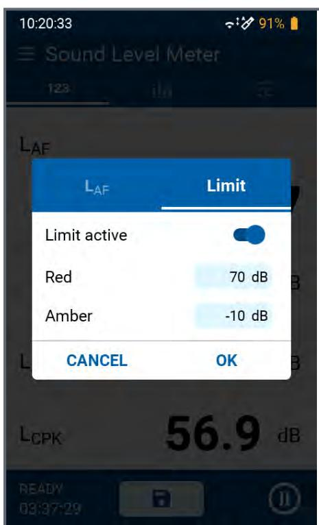
En "Límite" puede activar y definir un límite máximo ("Rojo") y un desplazamiento ("Desplazamiento naranja") para cada nivel individual. En cuanto el nivel sonoro supera el valor límite, la indicación del valor medido cambia a **rojo**. Si el nivel sonoro en el rango "offset" está directamente por debajo del límite, la pantalla cambia a **color ámbar** (advertencia). Los niveles inferiores se muestran en **negro**. Confirme la entrada de nivel con OK en el teclado en pantalla.
