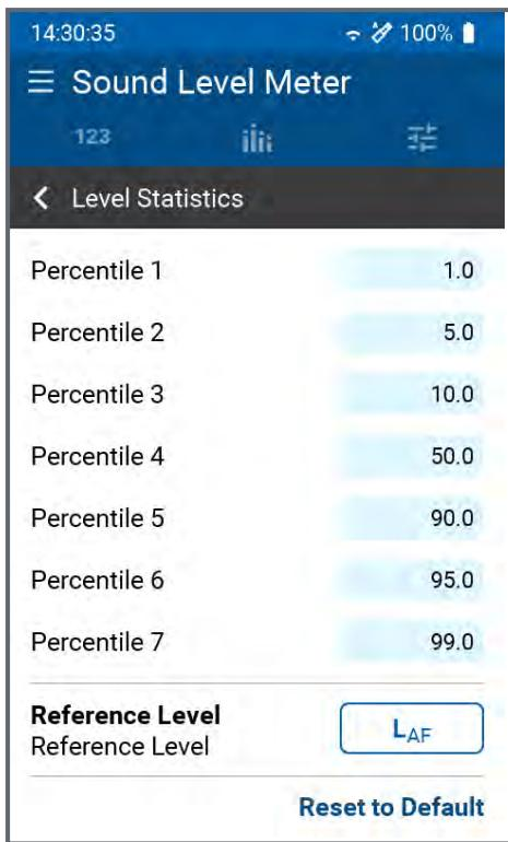
El instrumento calcula hasta 10 niveles percentiles diferentes para mediciones espectrales y de banda ancha. Estos datos representan la distribución estadística del nivel sonoro y se suelen utilizar para mediciones de ruido ambiental. Aquí, por ejemplo, LAFxx% corresponde a un nivel de ruido superado durante el xx% del periodo de medición. Los niveles sonoros del percentil 10 se pueden ajustar de forma flexible entre el 0,1% y el 99,9%.
