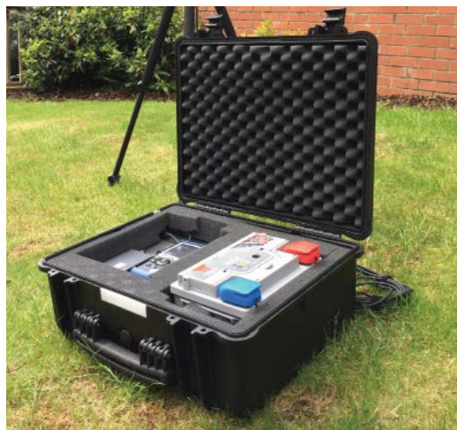
Station météo avec NetBox et analyseur XL2
