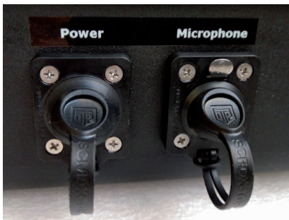
Connecteurs étanches pour le microphone et l'alimentation externe (configuration IP63)
