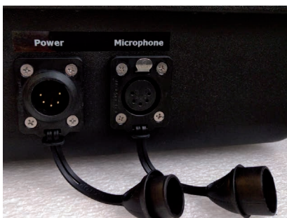
Bouchons de protection des connecteurs étanches pour le microphone retirés (configuration IP63)
