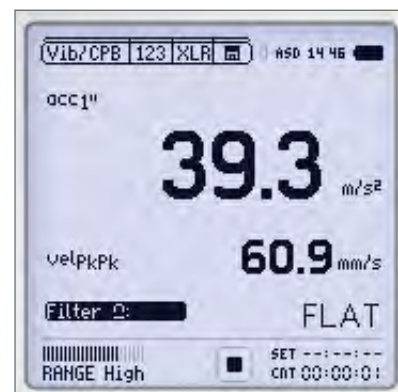
Mesure des vibrations à large bande
