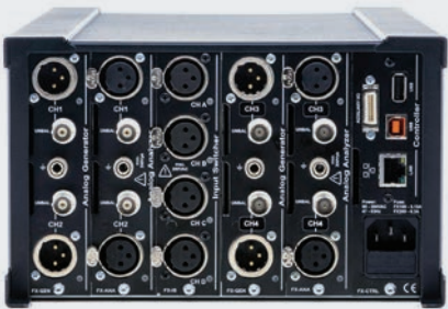
FX100のモジュール構成例
