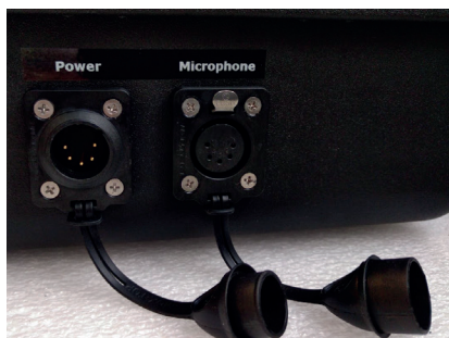
Entfernte Schutzkappen der wasserfesten Steckerverbindung (IP65 Variante)
